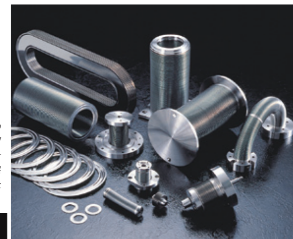
溶接ペロース製品。下のような金属の薄い板からドーナツ盤状の部品を切り出し、数十枚の外周、内周を交互に溶接して、フレキシブルな配管を作る
