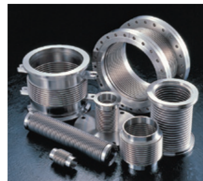
成形ペロース製品。大型配管などは液圧成形（金型の片方に液体を満たし、その圧力を利用して金属板を複雑な形状に成形する方法）で作る
