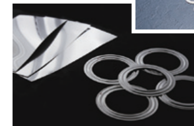
溶接ペロース製品。下のような金属の薄い板からドーナツ盤状の部品を切り出し、数十枚の外周、内周を交互に溶接して、フレキシブルな配管を作る
