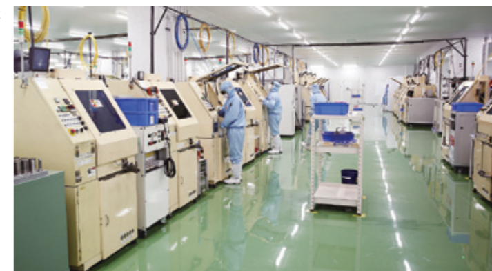
自動溶接装置 がずらりと並ぶ、 溶接ペロースの 生産工場
