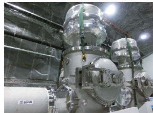
岐阜県の神岡鉱山内にある大型低温重力波望遠鏡「KAGRA」に使われた大型超真空管の製造も担当した
